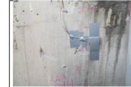
Şekil 10. Strain gauge sensörlerin korumaya alınması
