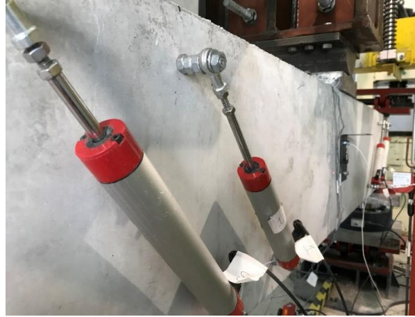
Şekil 3.b. Yerdeğiştirme ölçer yerleşimi
