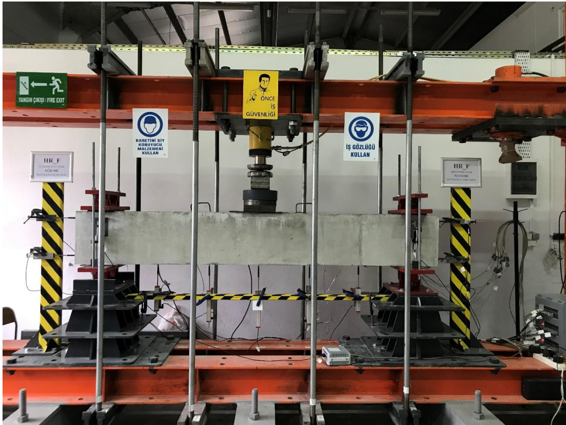
Şekil 1. Statik deneyler için eğilme çerçevesi ve veri toplama sistemi
